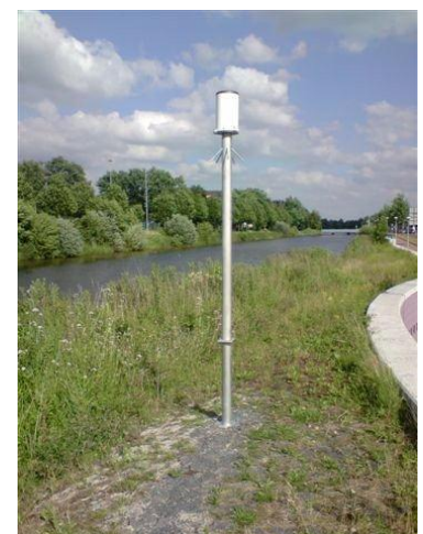
Meting van neerslag met de neerslagmeter, hier naast het Valleikanaal
